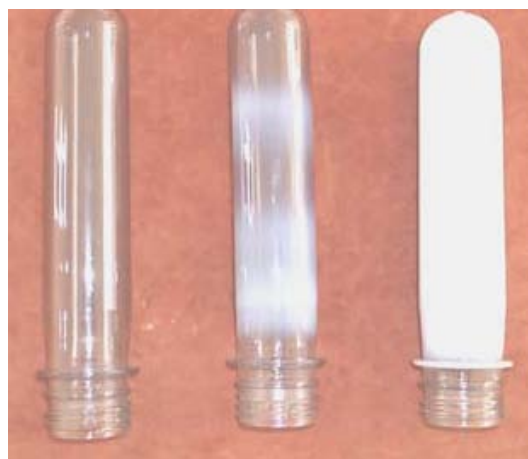
Figura 2.2 - Pré-formas de PET amorfa, parcialmente cristalina e cristalina (da esquerda para a direita) (RABELLO et al. , 2008).
