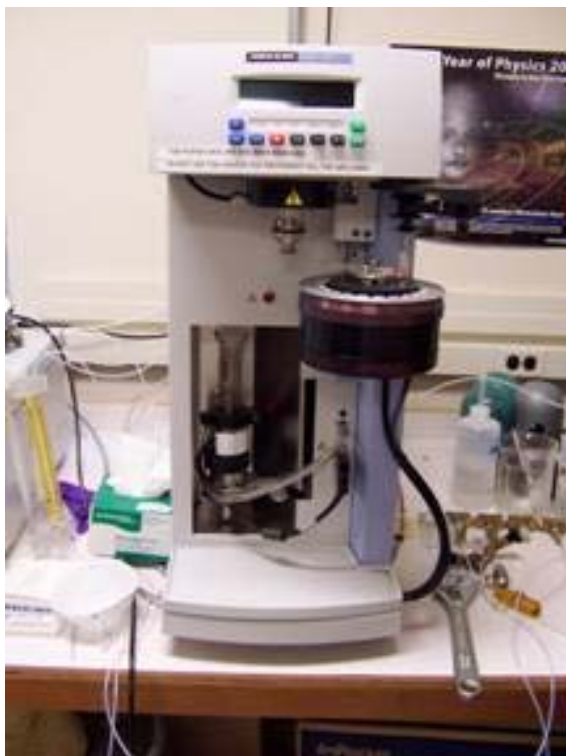
Figura 3.6 - Equipamento Perkin-Elmer utilizado para realizar as análises de TGA.
