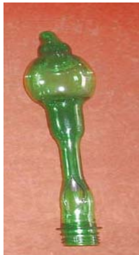
Figura 2.3 - Garrafa produzida a partir de uma pré-forma que estava parcialmente cristalizada (RABELLO et al. , 2008).
