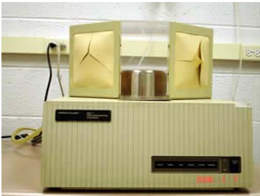
Figura 3.5 – Equipamento Perkin-Elmer, modelo DSC-7 utilizado para realizar as análises de Calorimetria Diferencial de Varredura.
