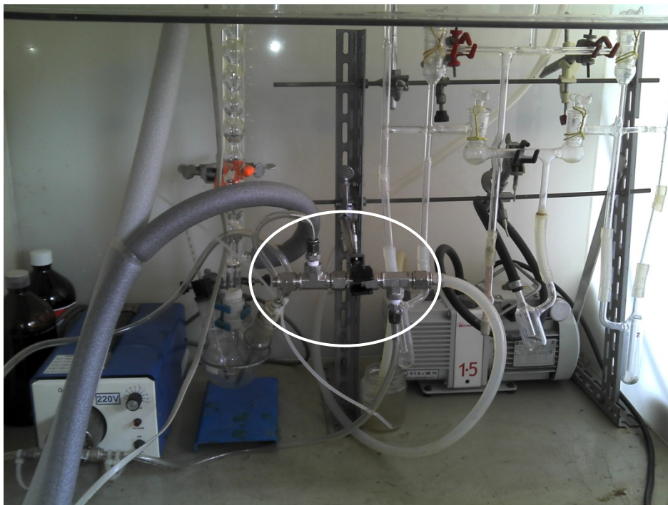
Figura 3.7: Sistema de pervaporação com módulo de fibras ocas
