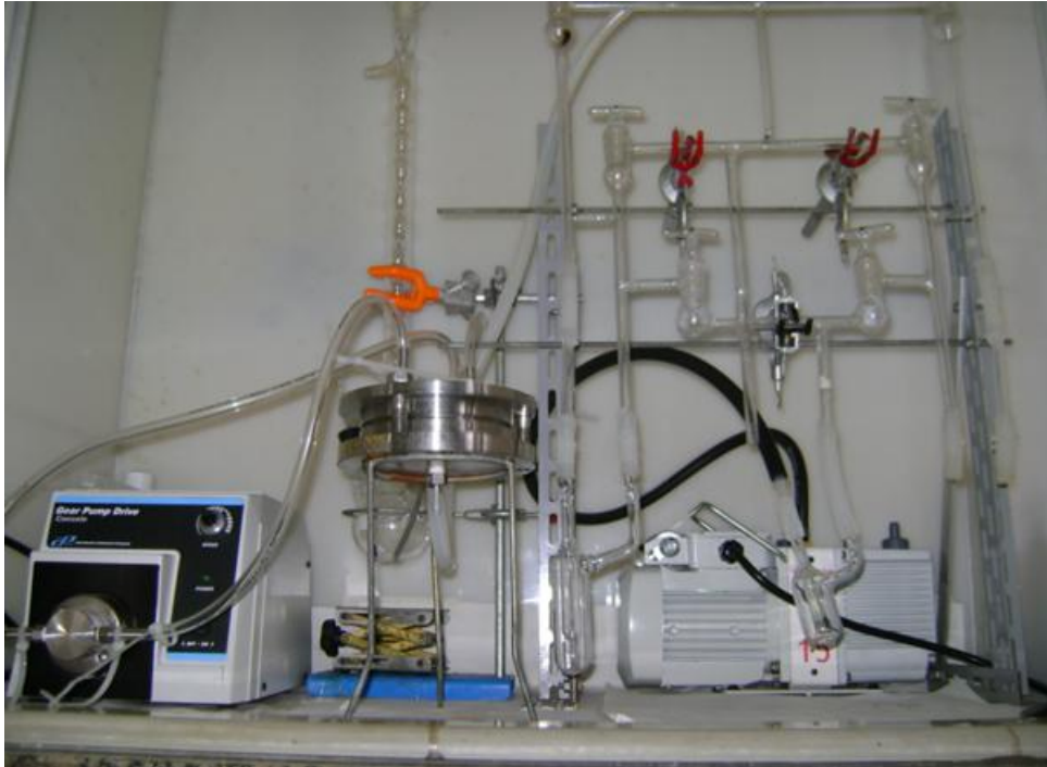
Figura 3.5: Sistema de pervaporação utilizando membranas planas
