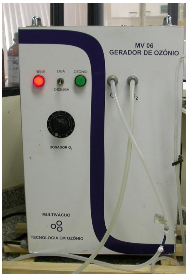
Figura 4.4 Gerador de ozônio utilizado nos ensaios de oxidação avançada
