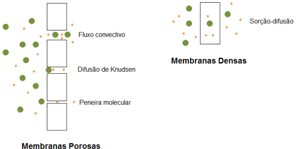
Figura 3: Mecanismo de permeação de gases através de membranas porosas e densas. (Adaptado do BAKER, 2004).
