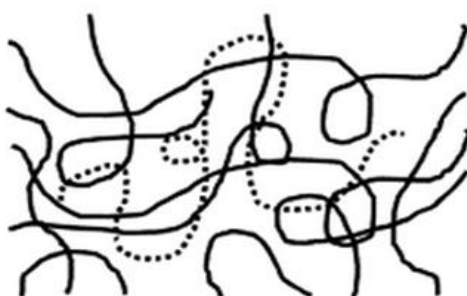
Figura 4.26 – Cadeias emaranhadas no estado amorfo (Fonte: AKCELRUD, 2007)
