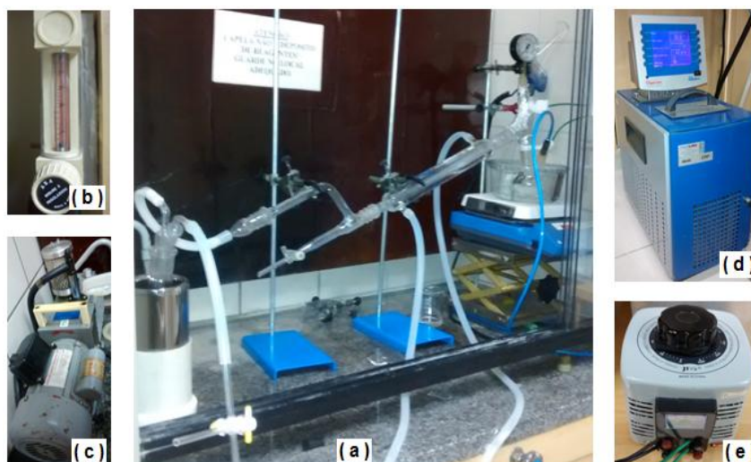
Figura 3.1 – (a) Aparato experimental, (b) Rotômetro, (c) Bomba de vácuo, (d) Banho térmico, (e) Controlador de tensão.
