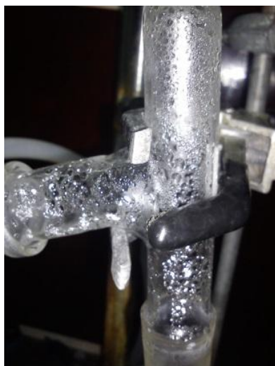
Figura 3.3 – Retorno de condensados ao meio reacional.
