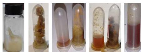
**Figura 4.23** – Produtos coletados produzidos nos ensaios de pirólise de misturas de polietileno de alta densidade/folhas secas de *Terminalia catappa* em diferentes proporções. Da esquerda para direita: 1/0, 2/1, 1/1, 1/2 e 0/1 (m/m) (vazão de N<sub>2</sub> de 80 mL min<sup>-1</sup> e temperatura de pirólise de 500 °C).
