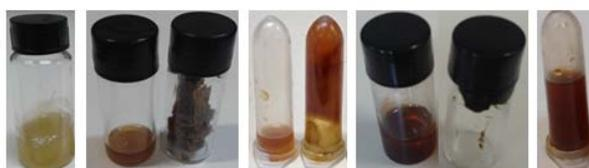
**Figura 4.22** – Produtos coletados nos ensaios de pirólise de misturas de polipropileno/folhas secas de *Terminalia catappa* em diferentes proporções. Da esquerda para direita: 1/0, 2/1, 1/1, 1/2 e 0/1 (m/m) (vazão de N<sub>2</sub> de 50 mL min<sup>-1</sup> e temperatura de pirólise de 450 °C).
