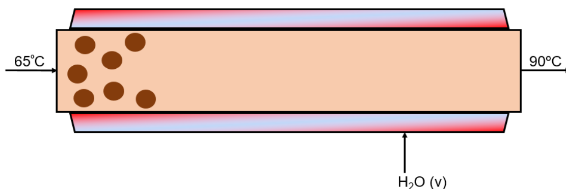
Figura 4.37 – Representação do secador tubular da unidade industrial em estudo
