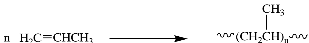
Figura 2.1 – Representação esquemática da reação de polimerização do propeno a PP.
