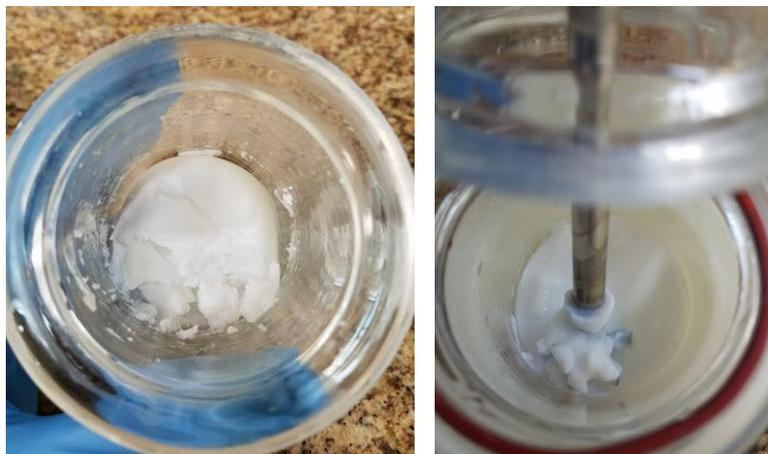
Figura V - 16. Agregados poliméricos observados na reação P(MMA-co-AA)10% +1,5%R. Isto também foi observado nas reações P(MMA-co-AA)12% +0,5%R e P(MMA-co-AA) 7,5% +2%R.
