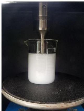
Figura IV - 1. Sistema de sonicação utilizado.
