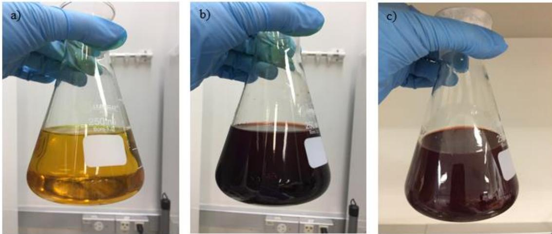
Figura 25: Suspensões da etapa de revestimento da amostra NPM\_D3. a) NPM, curcumina, água e etanol; b) NPM, curcumina, água, etanol e subsequente adição de hidróxido de amônio; c) NPM, curcumina, água, etanol e 24 h após adição de hidróxido de amônio.
