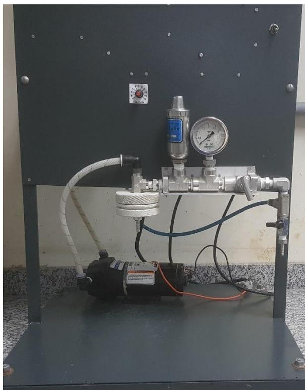
Figura 4.14 – Unidade experimental para determinação do SDI.
