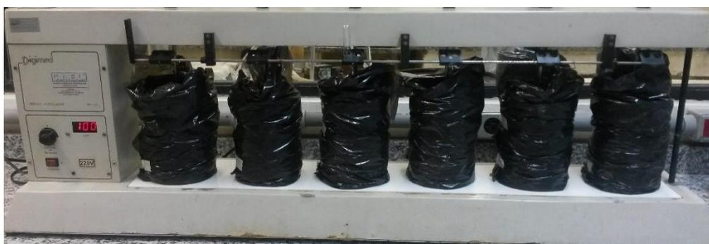
Figura 4.3 – Unidade experimental para o processo Fenton.
