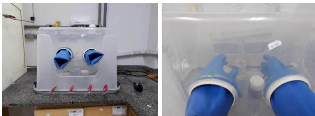
Figura 43. Fotografia da glove box usada para manipulação de reagentes.
