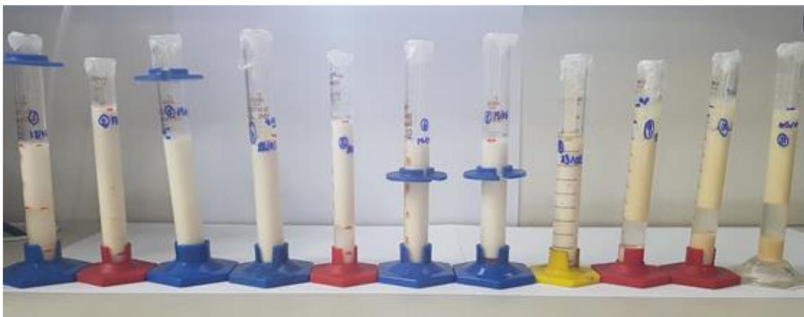
*Figura 4.12 – Provetas com amostras de emulsões após 15 dias: amostras 1 a 11, da esquerda para a direita*
