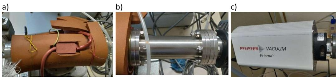
Figura 3.3 – Espectrômetro de massas: a) câmara de ionização; b) região livre de campo; c) analisador de massa.
