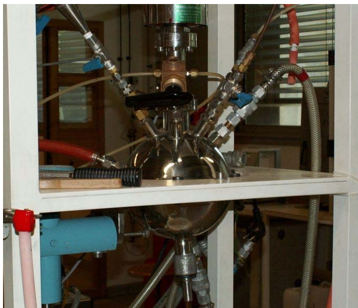
Figura 5.3 – Unidade Experimental Usada nas Reações (Turbo Sphère)
