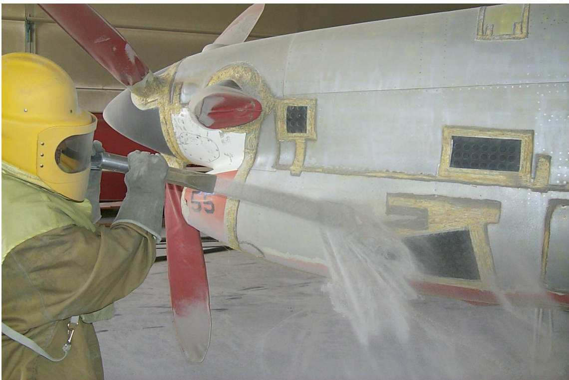
Figura 4. Decapagem da fuselagem da aeronave T-25 no PAMA-LS.
