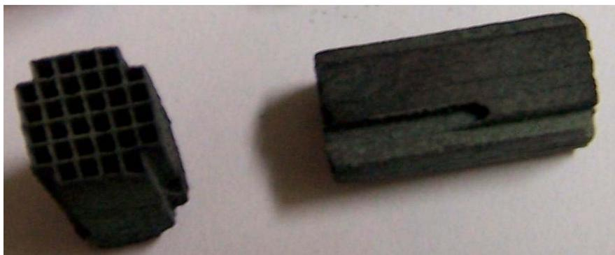
**Figura 5.6:** CuO/ $\gamma$ -Al<sub>2</sub>O<sub>3</sub>/corderita após calcinação a 500 °C.
