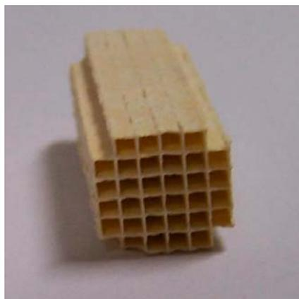
**Figura 5.2:** Estrutura monolítica cerâmica recoberta com  $\gamma$ -Al<sub>2</sub>O<sub>3</sub>: detalhe dos canais.
