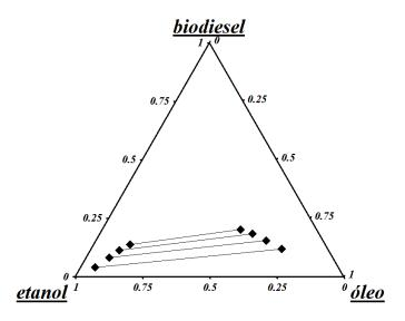
Figura 2.3 – Diagrama ternário do sistema biodiesel + etanol + óleo de soja. Temperatura de 300,15 K (LIU *et al.*, 2008).
