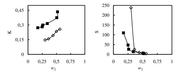
Figura 4.8 – Coeficiente de Partição do etanol e Seletividade do biodiesel em função da composição global do etanol. (■) ternário e (◊) quaternário.
