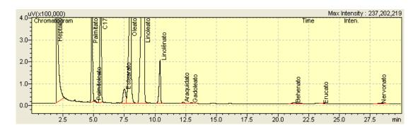
Figura 3.1 – Resultado da análise cromatográfica para o biodiesel etílico de soja.
