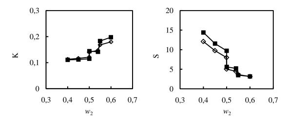
Figura 4.12 – Coeficiente de Partição (K) e Seletividade (S) do etanol em função de sua fração mássica na fase rica em glicerina. (■) ternário e (◊) quaternário.
