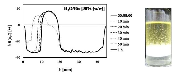
Figura 4.25 – Análise de estabilidade em emulsões de água-em-biodiesel através do Turbiscan.
