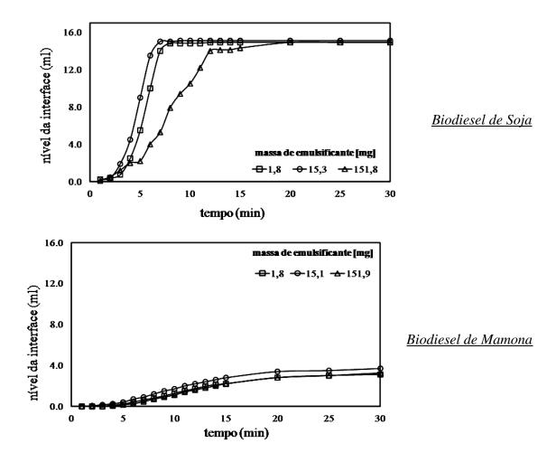
Figura 4.23 – Decantação de emulsões contendo os efluentes da transesterificação com óleo de soja e mamona.
