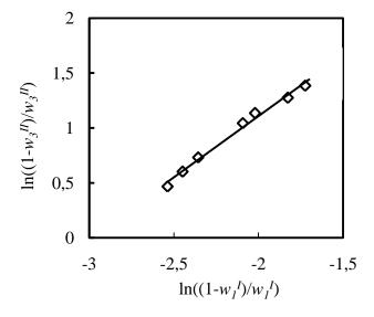
Figura 4.13 – Gráfico de Otmer-Tobias o sistema composto por Biodiesel (1) + Etanol (2) + Água (3) + NaCl (4) a 298 K.
