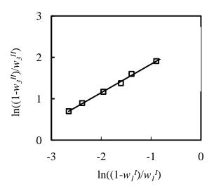
Figura 4.10 – Gráfico de Otmer-Tobias para o sistema composto por Biodiesel (1) + Etanol (2) + Glicerina (3) + Água (4) a 298 K.
