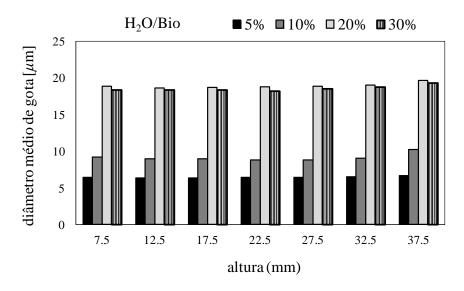
Figura 4.24 – Diâmetro de gota para as emulsões de água em biodiesel em concentrações de água variando entre 5 e 30 % em massa.
