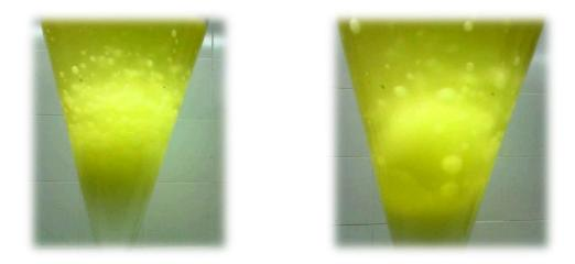
Figura 3.5 – Emulsão formada durante a purificação do biodiesel.
