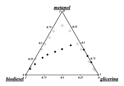
Figura 2.5 – Equilíbrio de sistemas contendo (♦) biodiesel de mamona (FRANÇA, 2008) e (♦) biodiesel de pinhão manso (ZHOU *et al.*, 2006) + glicerina + metanol a 298,15 K.
