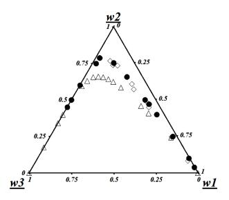
Figura 4.6 – Diagrama ternário para o sistema composto por Biodiesel (1) + Etanol (2) + Água (3) a 298 K. (•) Dados experimentais, (◊) ARDILA *et al.* (2012). Etil Laurato (1) + Etanol (2) + Água (3) a 298 K. (Δ) FOLLEGATTI-ROMERO *et al.* (2010).
