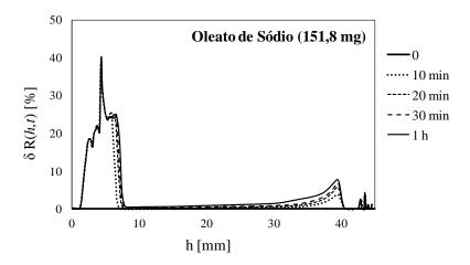
Figura 4.22 – Emulsão com mistura simulando efluente da reação de transesterificação com razão molar álcool:óleo de 9:1.
