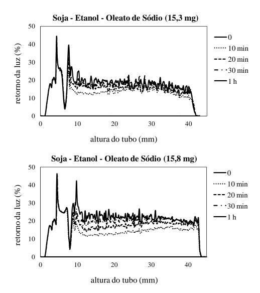
Figura AIV.1 – Réplica da emulsão contendo efluentes da reação de transesterificação.
