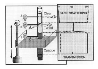
Figura 3.4 – Esquema de funcionamento do Turbiscan (MENGUAL et al., 1999).
