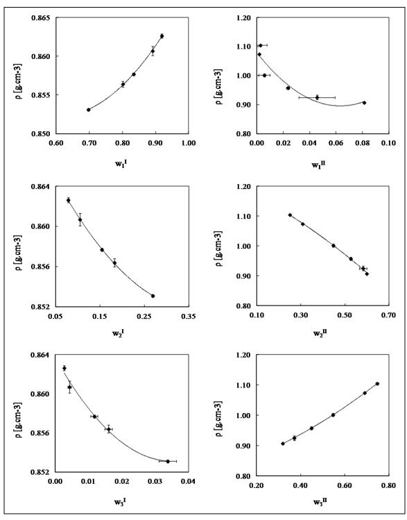
Figura AI.1 – Curvas de calibração para o sistema ternário composto por Biodiesel (1) + Etanol (2) + Glicerina (3) a 298 K.
