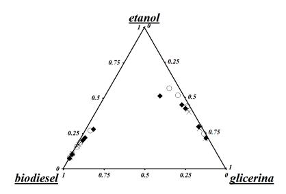
Figura 2.4 – Diagrama ternário do sistema biodiesel de soja + etanol + glicerina. (○) 300,15 K; (×) 323,15 K; (♦) 343,15 K (LIU *et al.*, 2008).
