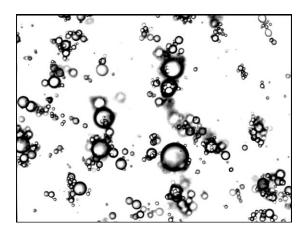
Figura 2.7 – Foto micrografia de emulsão constituída por gotas de óleo dispersas em fase aquosa contínua (McCLEMENTS, 2007).
