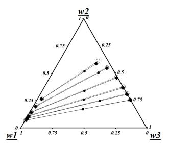
Figura 4.14 – Modelagem termodinâmica do sistema contendo biodiesel (1), etanol (2) e glicerina (3). (●) composição global, (○) experimental e (◆) UNIQUAC.
