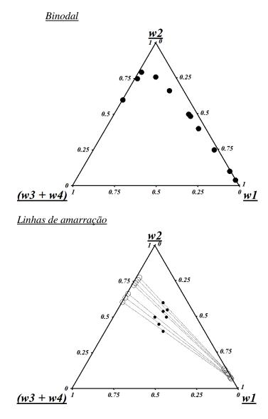
Figura 4.11 – Gráfico de Otmer-Tobias o sistema composto por Biodiesel (1) + Etanol (2) + Água (3) + NaCl (4) a 298 K.
