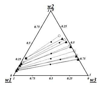
Figura 4.3 – Diagrama ternário para o sistema composto por Biodiesel (1) + Etanol (2) + Glicerina (3) a 298 K. (○) Dados experimentais e (▲) LIU *et al.* (2008).
