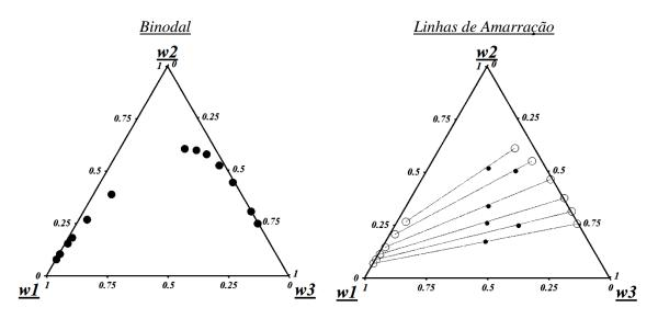
Figura 4.1 – Diagrama ternário para o sistema composto por Biodiesel (1) + Etanol (2) + Glicerina (3) a 298 K.
