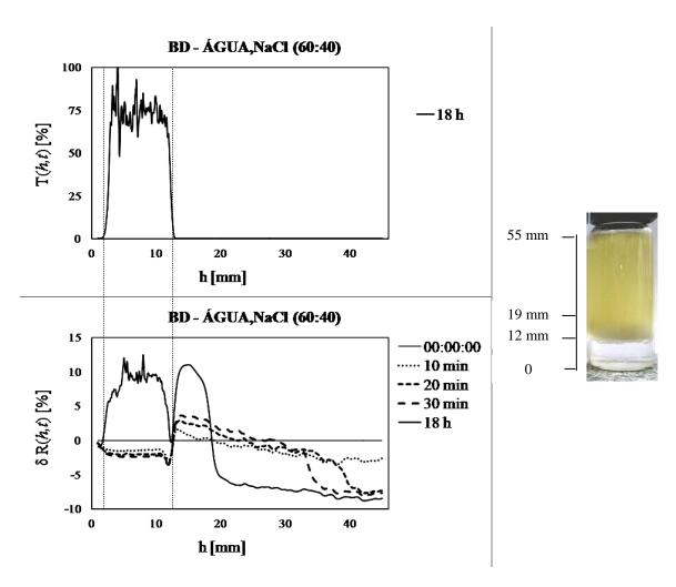
Figura 4.20 – Emulsão contendo solução saturada com eletrólito e fase rica em biodiesel do efluente da transesterificação de óleo de soja com etanol a 298 K. BD – ÁGUA,NaCl.
