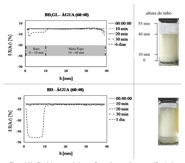
Figura 4.19 – Emulsões contendo água e efluente do reator de transesterificação de óleo de soja com etanol a 298 K. Foto das emulsões no tempo final, da esquerda para a direita: BD,GL – ÁGUA e BD – ÁGUA.
