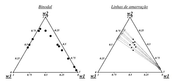
Figura 4.4 – Diagrama ternário para o sistema composto por Biodiesel (1) + Etanol (2) + Água (3) a 298 K.
