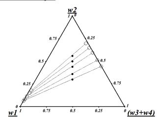
Figura 4.7 – Diagrama ternário para o sistema composto por Biodiesel (1) + Etanol (2) + Glicerina (3) + Água (4) a 298 K.
