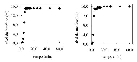
Figura AIV.2 – Réplica da decantação de emulsão contendo o efluente da transesterificação com óleo de soja.
