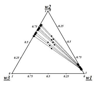
Figura 4.15 – Modelagem termodinâmica do sistema contendo biodiesel (1), etanol (2) e água (3). (●) composição global, (○) experimental e (◆) UNIQUAC.
