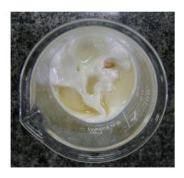
Figura 3.3 – Emulsão estável de água em biodiesel com emulsificante oleato de sódio.
