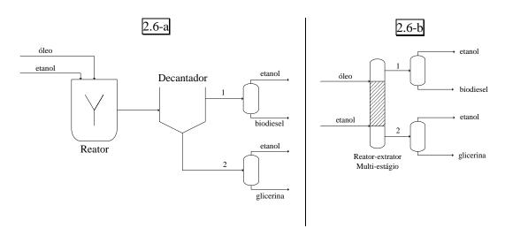
Figura 2.6 – Diagrama de produção do biodiesel – adaptado de GUTIÉRREZ *et al.* (2009). a) Configuração convencional. b) Configuração integrada envolvendo extração reativa. (1) corrente rica em biodiesel, (2) corrente rica em glicerina.
