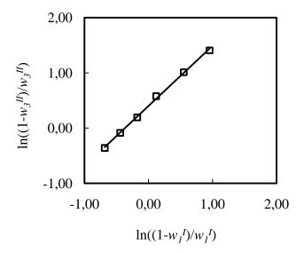
Figura 4.2 – Gráfico de Othmer-Tobias para o sistema composto por Biodiesel (1) + Etanol (2) + Glicerina (3) a 298 K.
