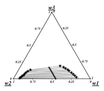
Figura 4.16 – Modelagem termodinâmica do sistema contendo óleo de soja (1), etanol (2) e biodiesel (3). (◆) Composição global, (○) LANZA *et al.* (2008), (♦) UNIQUAC.
