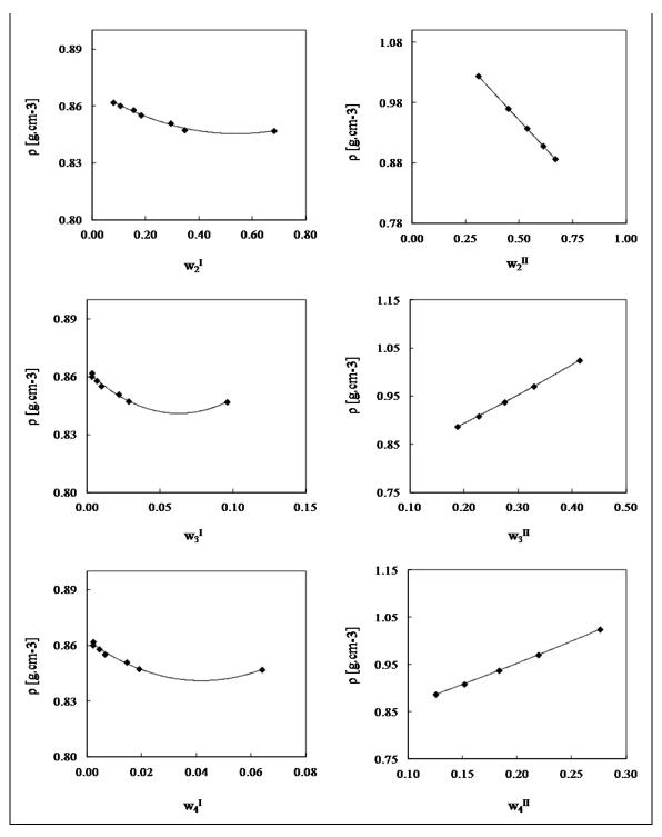
Figura AI.3 – Curvas de calibração para o sistema ternário composto por Biodiesel (1) + Etanol (2) + Glicerina (3) + Água (4) a 298 K.
