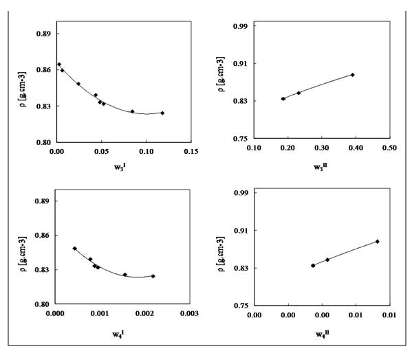
Figura AI.4 – Curvas de calibração para o sistema ternário composto por Biodiesel (1) + Etanol (2) + Água (3) + NaCl (4) a 298 K.
