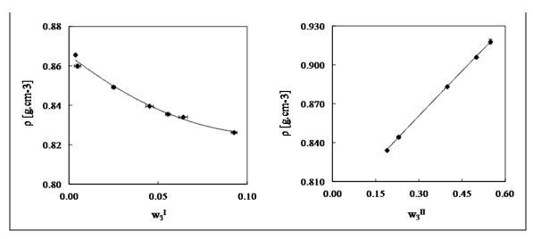
Figura AI.2 – Curvas de calibração para o sistema ternário composto por Biodiesel (1) + Etanol (2) + Água (3) a 298 K.
