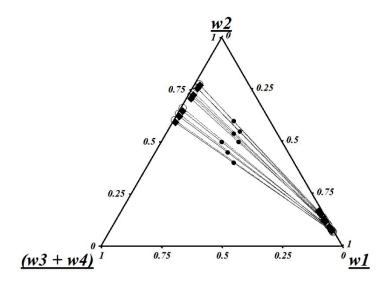
Figura 4.18 – Modelagem termodinâmica do sistema contendo biodiesel (1), etanol (2), água (3) e NaCl (4). (●) Composição global, (○) experimental e (◆) UNIQUAC.
