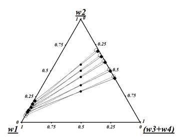
Figura 4.17 – Modelagem termodinâmica do sistema contendo biodiesel (1), etanol (2), glicerina (3) e água (4). (●) Composição global, (○) experimental e (◆) UNIQUAC.
