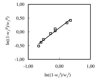
Figura 4.5 – Gráfico de Otmer-Tobias para o sistema Biodiesel (1) + Etanol (2) + Água (3) a 298 K.
