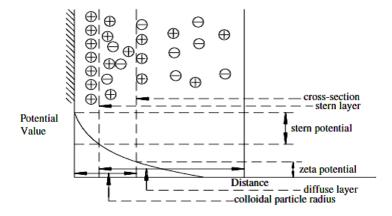
Figura 2.8 – Representação esquemática da dupla camada elétrica em sistema emulsionado (LIU *et al.*, 2004).
