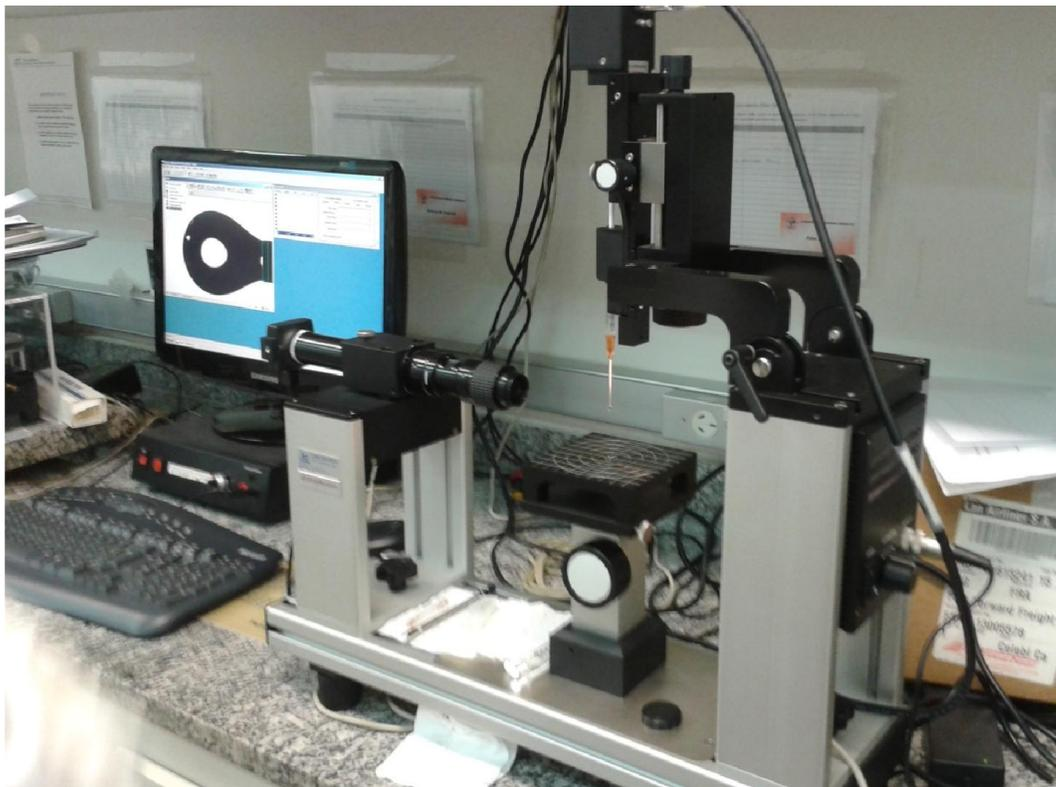
**Figura 4. 11:** Goniômetro usado para medir o ângulo de contato.
