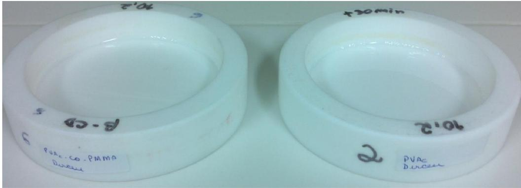
**Figura 4. 12:** Moldes de teflon para a produção dos filmes de PVAc e PVAc-co-PMMA.
