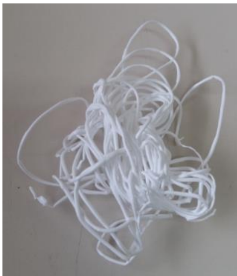
Figura 59 – Fibras ocas com área externa aderida, como consequência de tempos de precipitação muito lentos durante fiação.
